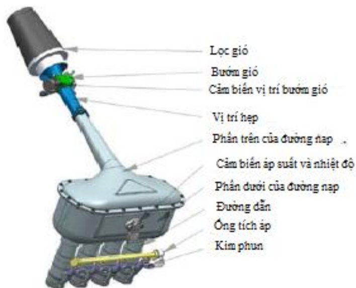
Hình 1.37: Kết quả họng nạp tối ưu theo kết quả mô phỏng của động cơ Yamaha YZF-R6 [16].
