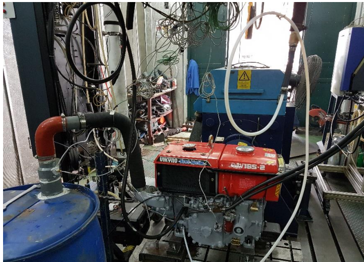
Hình 3.3: Động cơ sau khi lắp đặt xong trên băng thử.
