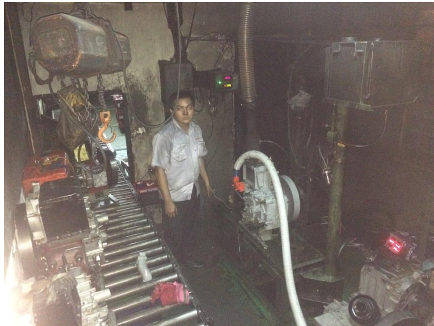
Hình 3.13: Thực nghiệm đánh giá tính năng hoạt động và hệ số nạp của động cơ VIKYNO RV165-2.
